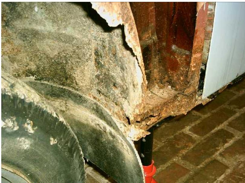
Massive Durchrostungen am Übergang Schweller/Gewei/A-Säule (Schraubkante des Vorderkotflügels) und Radschale vorn links nach Demontage des Kunststoffteils
